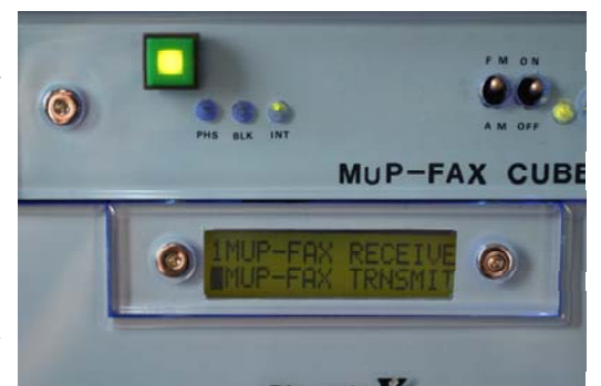
上段が5インチベイに組み込んだMuP-FAX部分で、左寄りの四角いボタンが切り替え制御用のプッシュスイッチ。切り替え選択が決定されるとスイッチ内のLEDが点灯する。下の3.5インチベイにLCD表示部を組み込んである。
